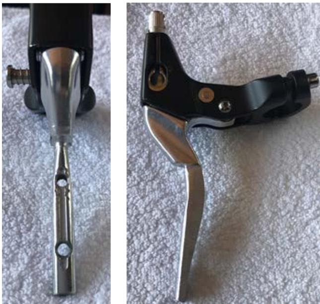
Die Bremshebelverlängerung wird aus einem Al-Rechteckprofil 20 mm x 15 mm geschnitzt, im wahrsten Sinn des Wortes. Mit einer Minidrill wird eine Ausfräsung in die Hebelverlängerung so eingebracht, dass der (abgefeilte) Bremshebel dort genau hinein passt und angeschraubt werden kann. Die äußere Form an den ursprünglichen Hebel angepasst, fertig. Was hier schnell geschrieben steht, dauert in Wirklichkeit einige Stunden mit Minidrill, Feile und Schleifsteinen.
