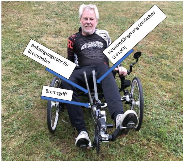
In vorliegenden Fall ergibt sich eine Hebelverlängerung von 190 mm, gemessen vom Anfang der Verlängerung bis zur Mitte der Bohrung für die Kniepad-Befestigung. Um den Bremshebel für ein auch optischen Ansprüchen genügendes Gesamtbild vorzubereiten, werden die äußeren Auflagen für die Kunststoffaufnahme weggefeilt, siehe nachfolgende Bilder.
