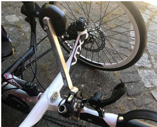
Damit die Bremsen bei Betätigung nicht einseitig ziehen, erfolgt die Einstellung für jede Zange einzeln. Der Hebelweg bis zum Greifen der Bremszange muss für beide Seiten identisch sein.
