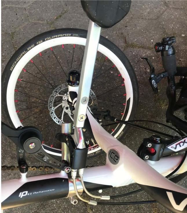
Mit einem Kabelbinder werden die Bremszüge abschließend am Zentralrohr des Rahmens fixiert. Von der anderen, rechten Seite sieht das Ganze so aus (der Lenkerstopfen ist noch nicht montiert):
